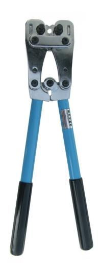
Verpresst nicht-isolierte Kabelverbinder und Rohrkabelschuhe nach DIN 46235 Preßbereich 6,10,16,25,35,50 mm² (Sechskant) schneller und komfortabler Pressbereichswechsel durch drehbare Profilscheiben
